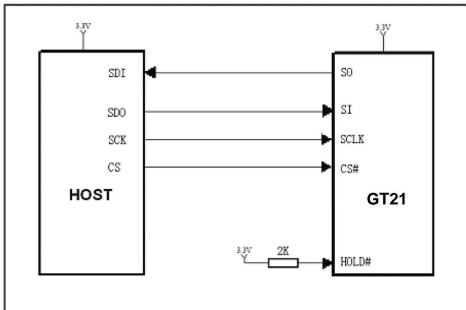
HOST CPU 主机 SPI 接口电路示意图
